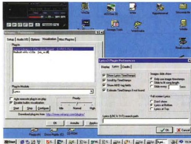
Configurazione del plug-in Lyrics all'interno di WinAmp. Da adesso in poi il player caricherà automaticamente il pannello esterno lyrics.exe per la dinamica dei metaeventi eventualmente allegati ai file MP3.
